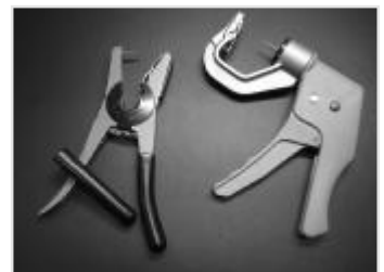
À gauche, la pince manuelle ovine (grise), dotée d'une gaine de latex et à droite, la pince automatique ovine (grise et bleue).
