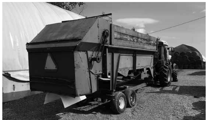
Distributeur ensilage : conçu à partir d'un épandeur à fumier et utilisé au champ avec un tracteur étroit pour verger, cette machine fait la distribution de l'ensilage dans les mangeoires de 6 pi de largeur.
