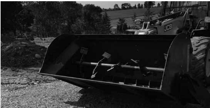
Bucket Mélangeur : benne mélangeuse, permet de mélanger et distribuer l'ensilage, les grains et les minéraux.
