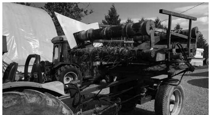
Pailleuse : une pailleuse à balle ronde fait maison, permet le paillage à partir de l'allée centrale
