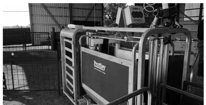
Trieur Prattley : balance trieuse Prattley, tirage à trois sorties contrôlées par l'indicateur de pesée. Les agneaux avaient plus de difficultés à entrer dans cet appareil. Le bruit des vérins pneumatiques ajoutait un élément de stress.
