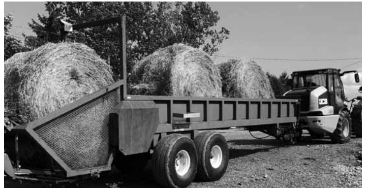
Dérouleuse balle ronde : fabriqué maison, cette dérouleuse est utilisée au pour alimenter les moutons au pâturage l'hiver. Elle a une capacité de cinq balles rondes.
